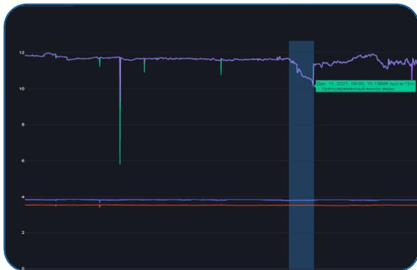
Гидратообразование в импульсной трубке датчика давления скв. № 10-3
